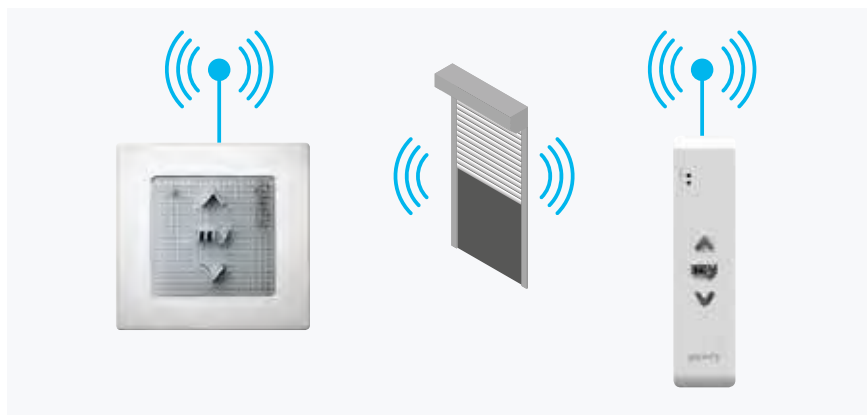
Les systèmes radio-commandés sont idéals pour la rénovation, les commandes sans fil vous évitent tout câblage dans les murs, seul le moteur doit être raccordé au réseau électrique.
